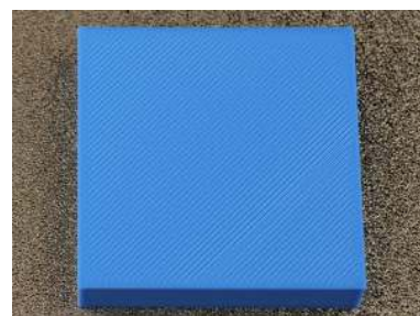
顶面缝隙 (挤出不足)
