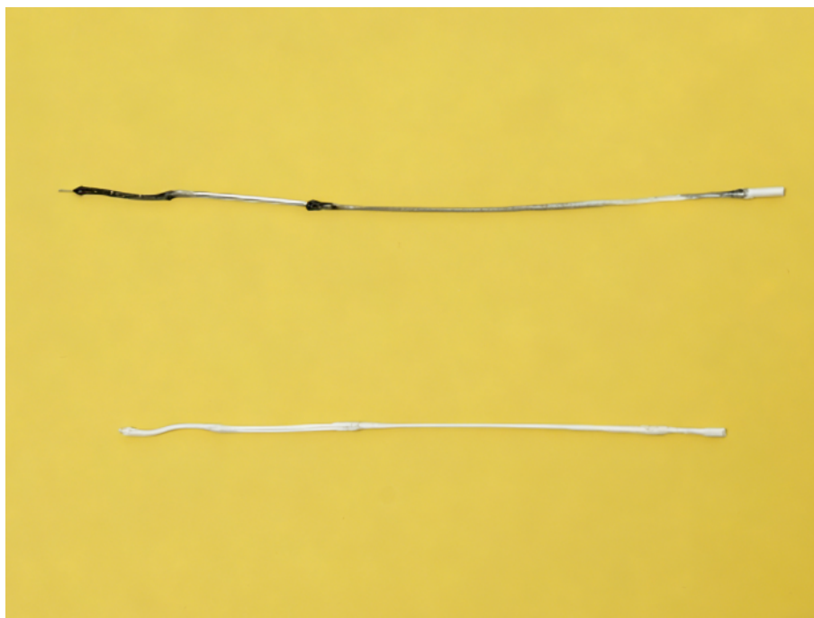
初次冷拔（上）和多次冷拔（下）
